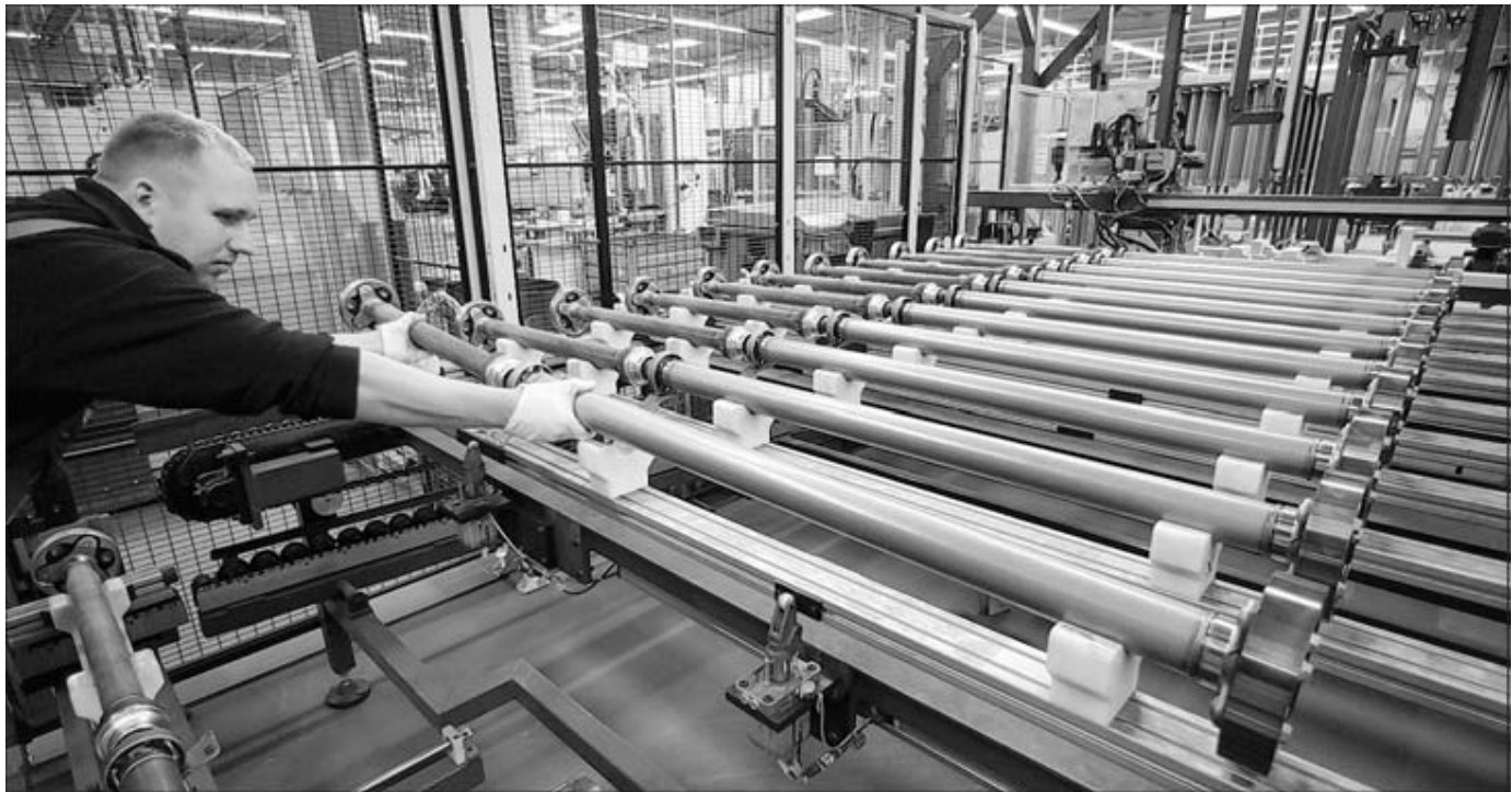
Rohlinge für zukünftige Antriebswellen für Kraftfahrzeuge werden auf einer Anlage transportiert.
